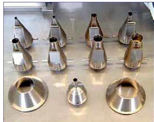
Obr.2: Některé konfigurace trysek, které se běžně používají v selektivních pájecích procesech
