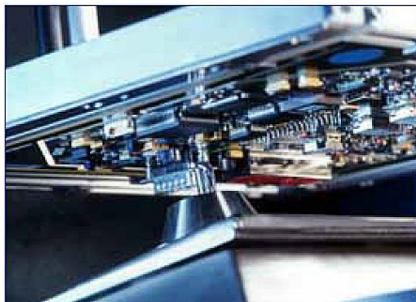
Obr. 1: Pájení selektivních bodů na spodní straně desky
