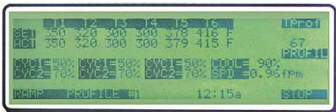
Obr.6: Zabudovaný ovládací interface na vícezónové peci
