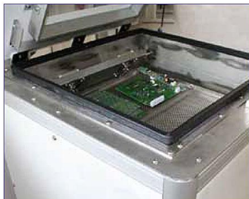
Obr.4: Pec pro přetavování v parách, ukazující desku, zavěšenou nad ložem s tekutinou, která přenáší teplo.
