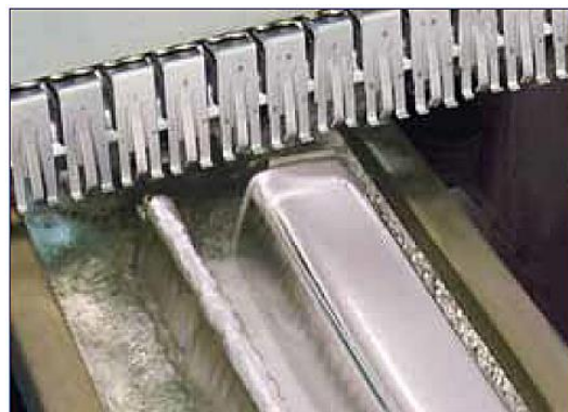
Obr.1: Turbulentní vlna (vlevo) a laminární vlna (vpravo) ve stejném systému
