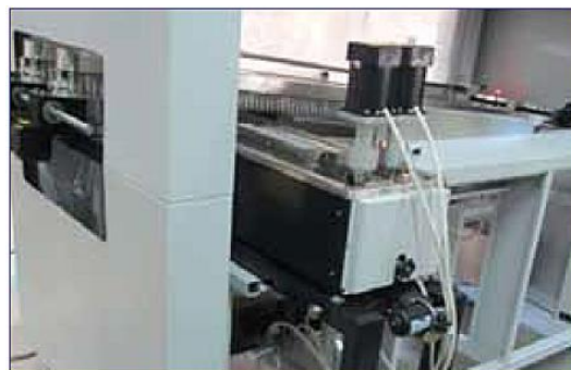
Obr. 12: Nádrž na pájku s pojezdovým systémem
