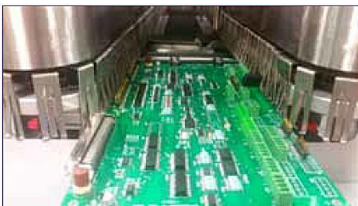
Obr.6: Titanové prsty (nebo klipsy) svírající desky při průchodu vlnovým zařízením
